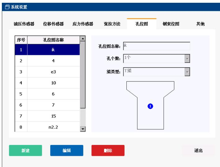
图 3.15 孔位图设置
