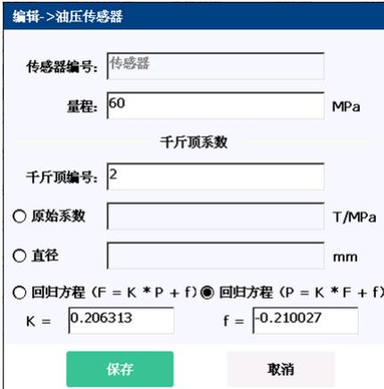
图 3.5 编辑油压传感器
