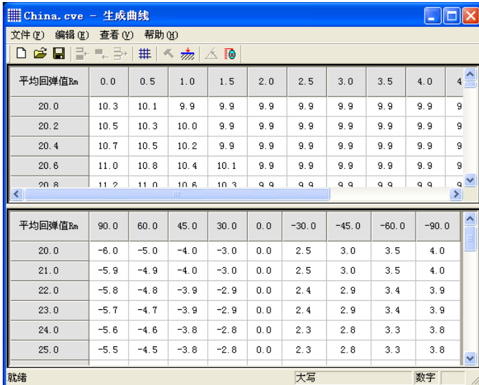
图 3.10 建立回弹曲线软件界面
