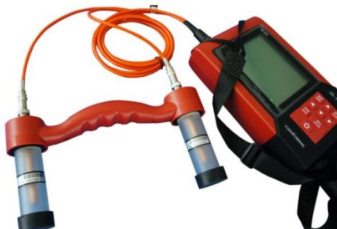
图 4-7 双电极连接示意图
