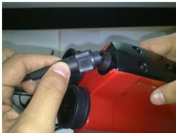
图 4-2 钢筋传感器连接
