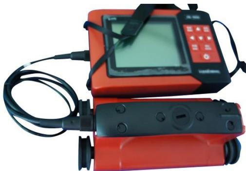
图 4-1 钢筋传感器连接主机
